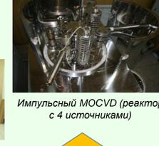
Импульсный МОСVD реактор с 4 источниками
