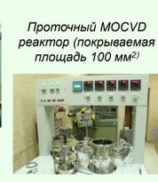
Проточный МОСVD реактор (покрываемая площадь 100 мм²)
