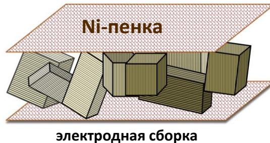
Размещение массивов между слоями никелевой пенки увеличивает электрическую связанность нанотрубок в электрохимической ячейке
