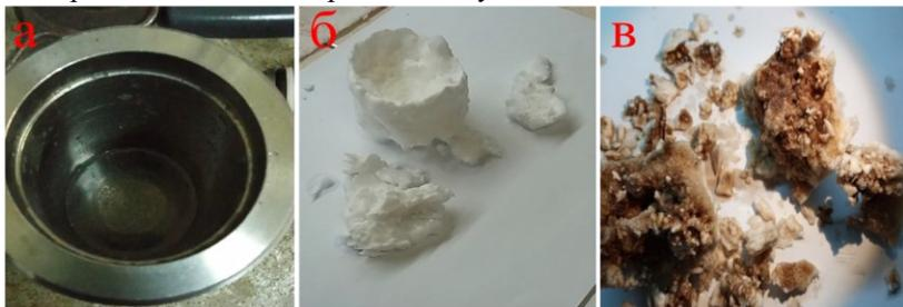
**Рисунок 4.** Реакционная ячейка после экспериментов без перемешивания с а) водой; б) SDS; в) гуминовой кислотой
