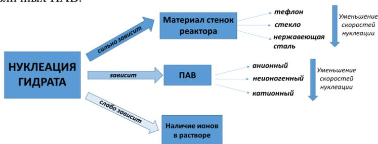
**Рисунок 10.** Схема факторов, влияющих на нуклеацию исследуемых в работе газовых гидратов
