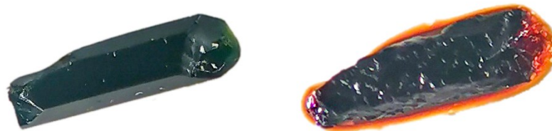
Рис. 65. Вид кристалла [\text{Cu}(\text{hfac})_2\text{L}^{n\text{-Pr}}]_2\text{-II} до (слева) и после нагревания до 320 К (справа) [128].
