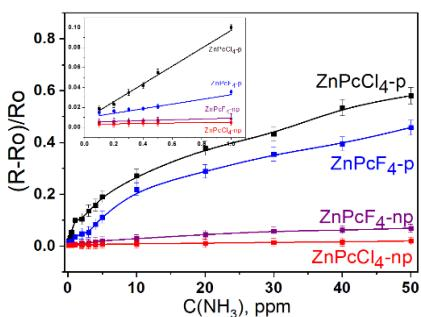
Рисунок 10. Зависимость сенсорного отклика пленок ZnPcF<sub>4</sub>-р, ZnPcF<sub>4</sub>-np, ZnPcCl<sub>4</sub>-р и ZnPcCl<sub>4</sub>-np от концентрации NH<sub>3</sub>
