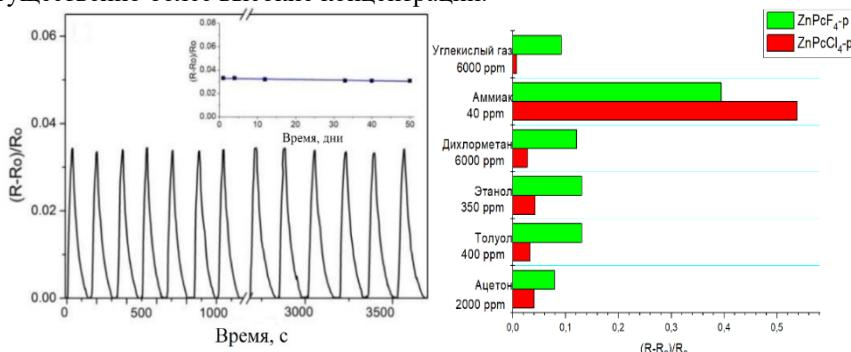
Рисунок 14. Воспроизводимость и стабильность сенсорного отклика пленки ZnPcCl<sub>4</sub>-р при введении 0.4 ppm аммиака в течение длительного периода времени
