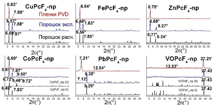
Рисунок 6. Дифрактограммы порошков и пленок MPcF<sub>4</sub>-np
