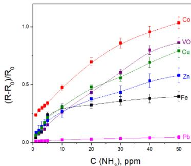
Рисунок 13. Зависимость сенсорного отклика пленок  $\text{MPcCl}_4\text{-p}$  от концентрации аммиака (1-50 ppm) при
