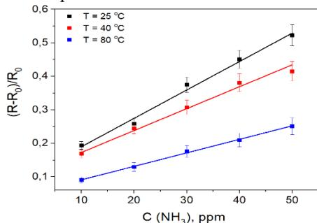
Рисунок 16. Зависимость сенсорного отклика пленки ZnPcCl<sub>4</sub>-р от концентрации NH<sub>3</sub> при температурах 25, 40 и 80 °C
