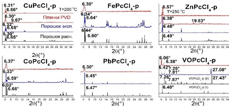
Рисунок 8. Дифрактограммы порошков и пленок MPcCl<sub>4</sub>-р
