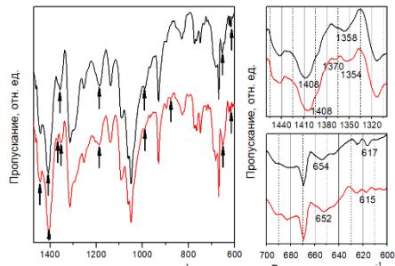
Рисунок 11. ИК-спектры пленки CoPcCl<sub>4</sub>-р (черная линия) и той же пленки в атмосфере аммиака (красная линия)
