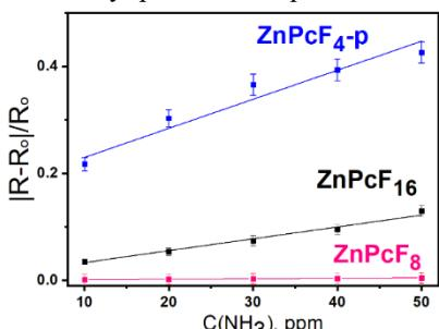
Рисунок 9. Зависимость сенсорного отклика пленок ZnPcF<sub>4</sub>-р, ZnPcF<sub>8</sub> и ZnPcF<sub>16</sub> от концентрации NH<sub>3</sub>
