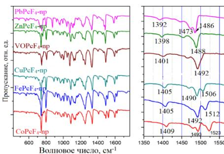
Рисунок 5. ИК-спектры фталоцианинов MPcF<sub>4</sub>-np (M=Co, Cu, Zn, Fe, Pb, VO)
