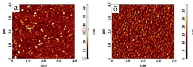
Рисунок 7. Морфология пленки CoPcF<sub>4</sub>-np после осаждения (а) и после нагрева при температуре 200 °C в течение 2 часов (б)
