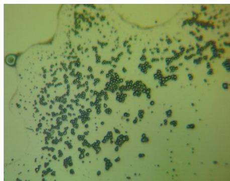
Рис.2. Частицы порошка, полученные методом лазерной абляции
