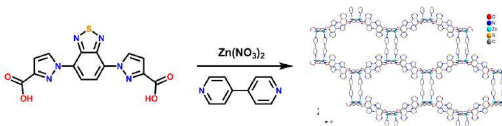
Рис. 1. Схема синтеза МОКП [Zn 2 (bpy)(L s ) 2 ].
