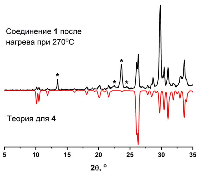
Рисунок 60. Сравнение дифрактограммы продукта разложения  $[\text{V}_4\text{OSe}_8\text{I}_6] \cdot \text{I}_2$  (**1**) при 270°C с расчётной дифрактограммой  $[\text{V}_4\text{OSe}_8\text{I}_5]_\infty$  (**4**). Звёздами обозначены несовпадающие рефлексы, соответствующие фазам Se,  $\text{V}_x\text{O}_y$
