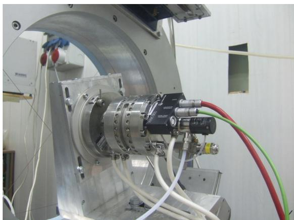
*Рис.12(а). Рентгеновская высокотемпературная камера реактор XRK-900*
