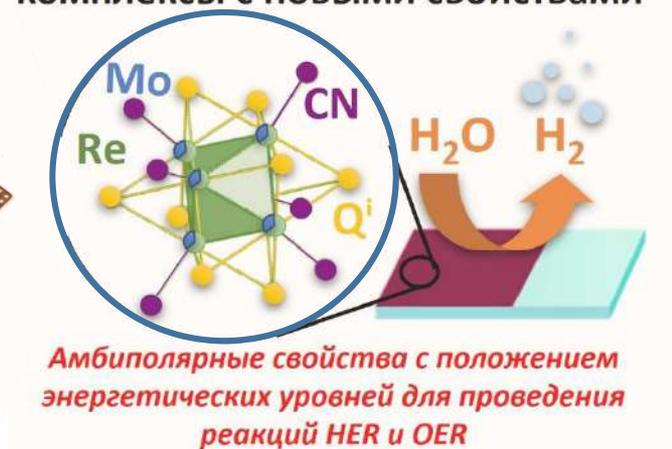
*Сочетание двух типов металла в кластерном ядре позволяет оптимизировать оптические и электронные характеристики материалов.*
